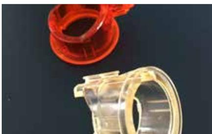
Auf über 30 Spritzgussmaschinen produziert Boida jährlich ca. 70 Millionen technische Kunststoffartikel, darunter auch die abgebildeten Automobilteile in Großserie.
