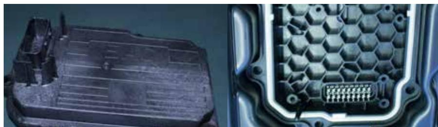
Der abgebildete Gehäusedeckel wird bei Boida in 2K-Technik gefertigt. Besondere Ansprüche werden an die Abdichtung und damit an die Ebenheit des Artikels gestellt. Das zugehörige Werkzeug wurde ursprünglich in Portugal gefertigt. Um es lauffähig zu machen, wurde es vom Kunden zu Boida überstellt. Nach zahlreichen aufwendigen Anpassungen konnte Boida damit produzieren. Inzwischen hat Boida ein ähnliches Werkzeug komplett im eigenen Hause entwickelt und gefertigt.
