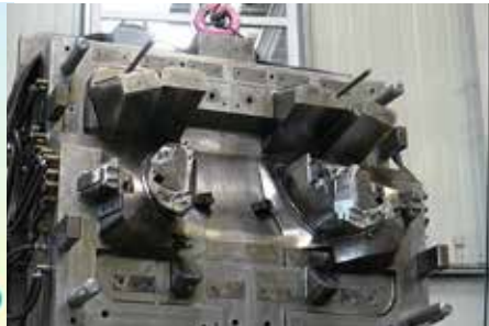
Bild links: Scheinwerfergehäuse für einen LuxusSportwagen. Für die Produktion müssen 2,5 m 3 Stahlform auf die Spritzgießmaschine montiert werden. Im Bild rechts eine Formhälfte des zugehörigen Werkzeugs.
