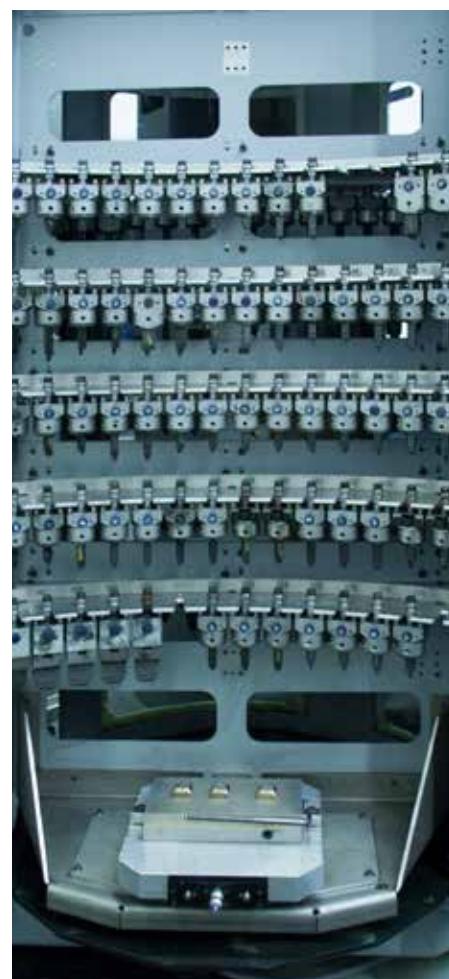
Über eine zentrale Robotik werden zwei Erodiermaschinen von OPS-Ingersoll aus einem Magazin mit Elektroden versorgt. Zusammen mit dem Palettenwechsler erlaubt diese Ausstattung über einen längeren Zeitraum den mannlosen Betrieb in der Senkerosion. Das angeschlossene Elektroden-Magazin ist dazu in der Regel prall gefüllt (rechts).
