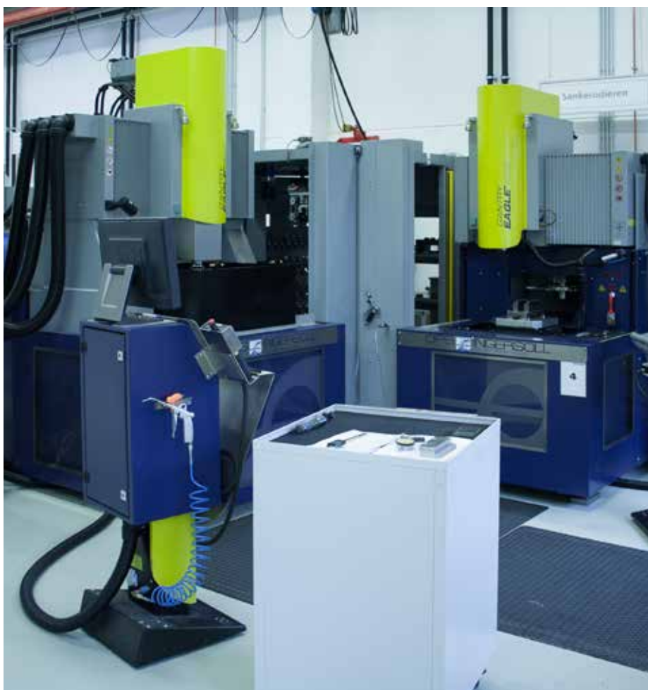
Über eine zentrale Robotik werden zwei Erodiermaschinen von OPS-Ingersoll aus einem Magazin mit Elektroden versorgt. Zusammen mit dem Palettenwechsler erlaubt diese Ausstattung über einen längeren Zeitraum den mannlosen Betrieb in der Senkerosion. Das angeschlossene Elektroden-Magazin ist dazu in der Regel prall gefüllt (rechts).
