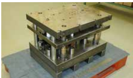
Folgeverbundwerkzeug aus dem Hause Ernst Keller mit dem zugehörigen Folge-verbundstreifen für einen Schlosshalter.
