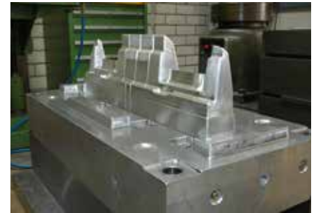
Ein großer Anteil der Prototypenwerkzeuge wird aus hochfesten Aluminium-Legierungen gefertigt. Im Bild die Werkzeugzeugunterhälfte der links abgebildeten Konstruktion.
