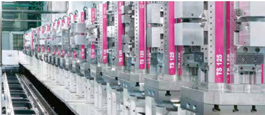
Die Spezialität der Hilma-Römhheld GmbH sind Mehrfach- und Turmspannsysteme, auf denen mehrere Schraubstöcke montiert sind. Mit ihnen lässt sich die Zahl der Werkstückwechsel deutlich verringern. (Bild: Hilma-Römhheld)
