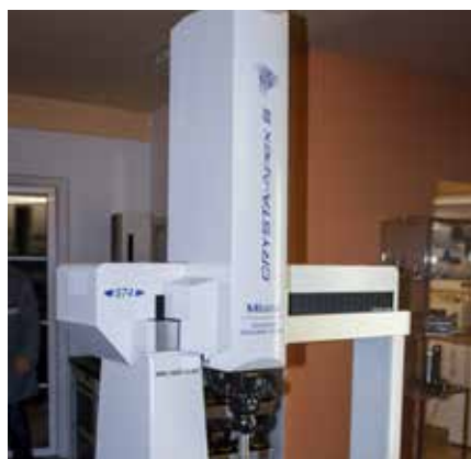
Alle Teile, die für die Erdölindustrie bestimmt sind, werden auf der eigenen Mitutoyo-Messmaschine mit selbsterstellten Messprogrammen komplett vermessen.
