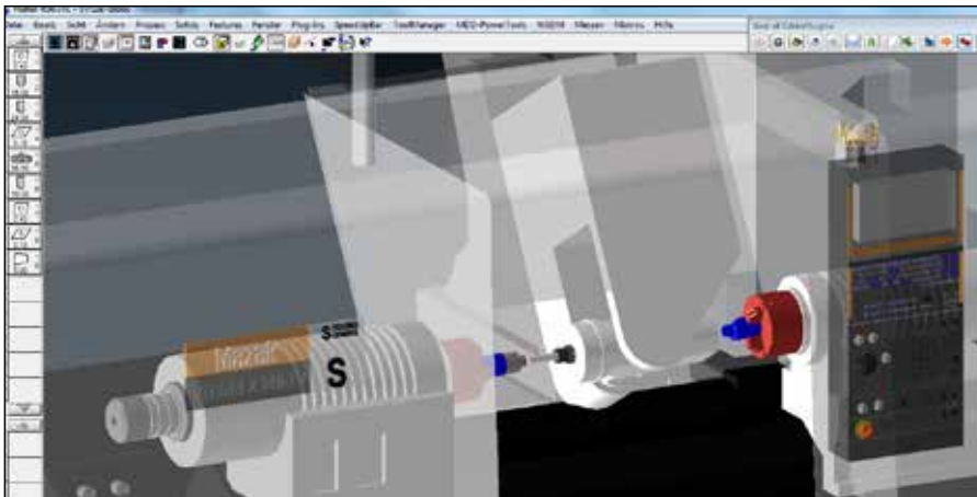
Maximale Sicherheit beim Dreh-Fräsen und bei der MTM-Bearbeitung: Die Maschinensimulation zeigt anschaulich, ob es zu kritischen Bearbeitungssituationen kommt. Für die Simulation steht ein exaktes Maschinenmodell der MAZAK Integrex 200-IV zur Verfügung.
